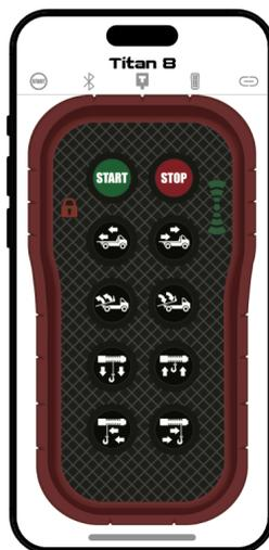
Al acceder desde un dispositivo móvil al receptor, se crea una imagen digital del mando físico y permite controlar las salidas del receptor como si de un mando físico se tratara.
